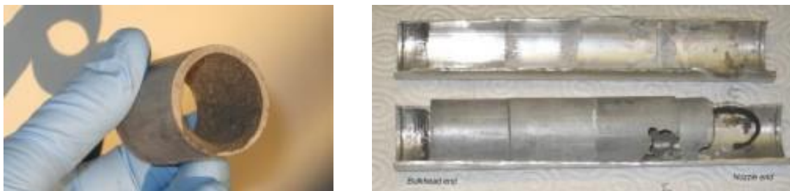
FIGURA 9. RESTOS DE UN SEGMENTO DE PASTILLA DESPUÉS DE AUTO EXTINGUIRSE (IZQUIERDA). UN MOTOR A24-B1 SECCIONADO CON RESTOS DE PASTILLAS.
