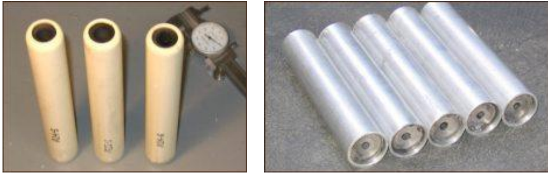
FIGURA 4. MOTORES DE PVC (IZQUIERDA) Y MOTORES DE ALUMINIO (DERECHA) EMPLEADOS EN UN TEST DE IGNICIÓN DE FÓRMULAS DE NITRATO DE AMONIO. LOS MOTORES DE ALUMINIO DE 25 MM DE DIÁMETRO SE USARON CON CIERTAS FÓRMULAS EMPEZANDO POR EL A20.
