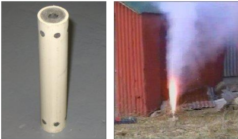
FIGURA 3. ENCENDIDA ESTÁTICA DE UN A14-A1, MAYO DE 2005. MOTOR DE UN SOLO USO DE PVC CON UNA TOBERA DE CEMENTO HIDRÁULICO.
