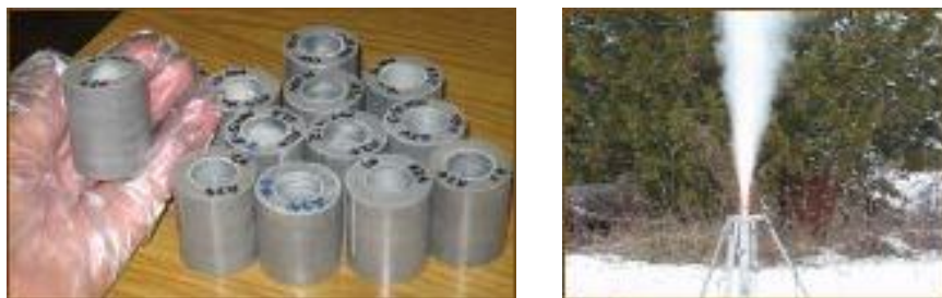
FIGURA 10. PASTILLAS DE PROPELENTE A24 PARA TESTS ESTÁTICOS. IGNICIÓN DEL MOTOR A24-B3.
